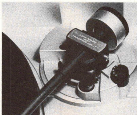
Foto 5. De lichtgewicht arm is uitstekend, zonder enige speling, gelagerd. Naaldkracht en dwarskrachtcompensatie kunnen nauwkeurig worden ingesteld.
